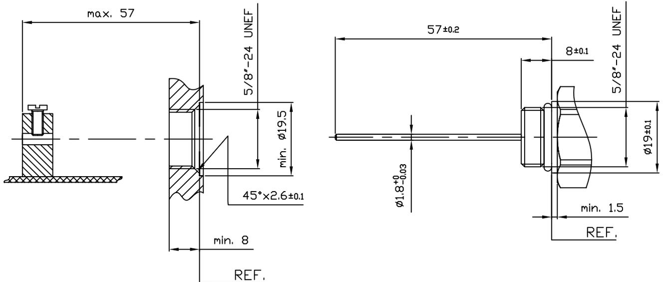
La serie 5/8 (rosca 5/8" UNEF) son conectores especialmente diseñados para ser instalados en cajas de redes de distribución de CATV. De esta forma se define el conector macho con acoplamiento a rosca. Su aplicación se centra en redes troncales de televisión por cable. Su impedancia característica es de  $75 \Omega$ , con frecuencias efectivas de utilización de hasta de 2 GHz.
